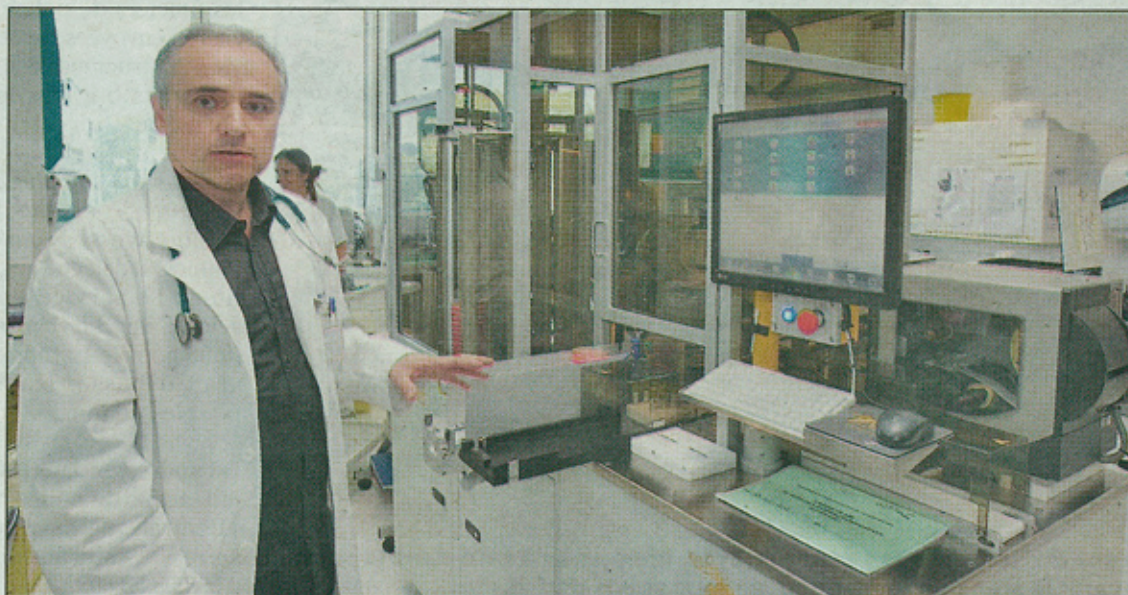
Le Dr Alain Lafeuillade devant le WASP (walk away specimen processing), une machine qui ensemence les prélèvements au rythme de 180 boîtes par heure. Il n'en existe que quatre en France. (Photos Patrick Blanchard)
