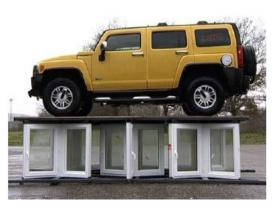
18 châssis de 700 x 1000 mm de la gamme TRYBASAFE R40 M+ (gamme sécurité) ont servi à ce test de résistance.
