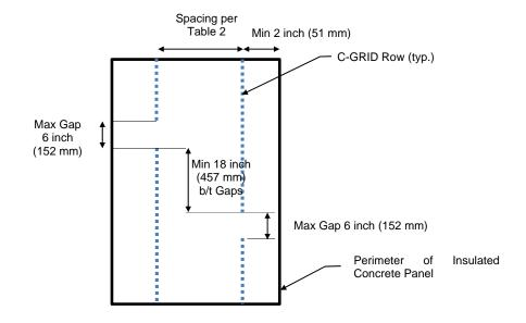
FIGURE 2—C-GRID PLACEMENT
