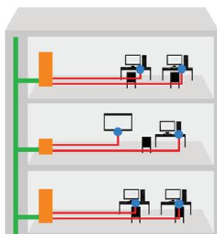
Cette solution permet de profiter au mieux des avantages des 2 médias. Vous disposez ainsi d'un cœur de réseau en fibre optique, avec une réduction des coûts de maintenance sur le long terme.
